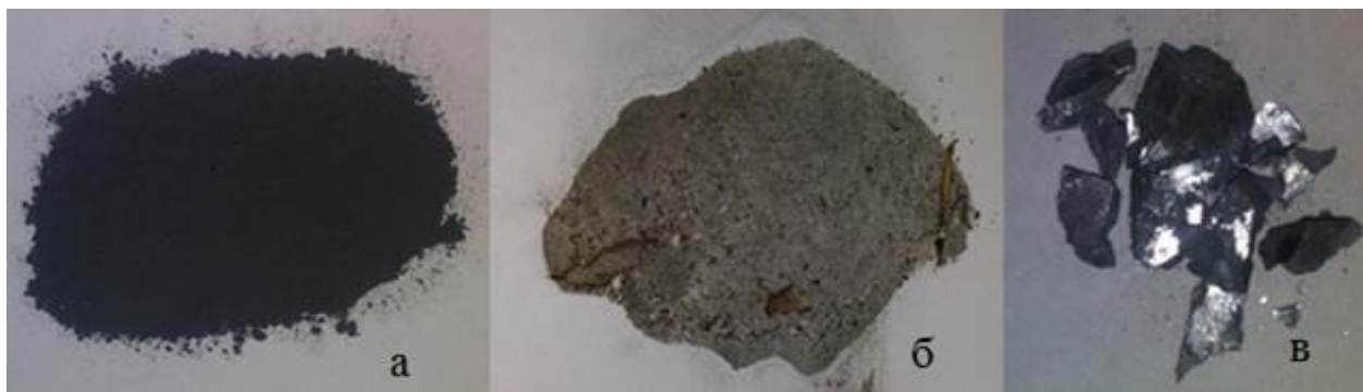
Рис. 1. а – сурьмяный концентрат; б – металлизированный кек; в – металлическая сурьма после плавки кека
