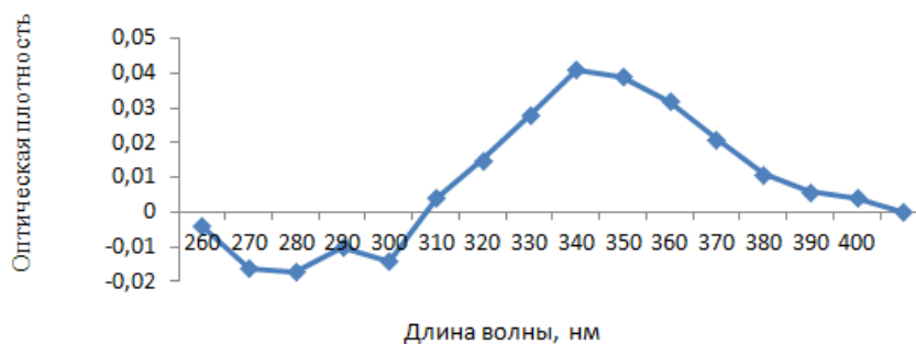
Рис. 3. УФ-спектр исходного фильтрата отбели целлюлозы (раствор сравнения фильтрат после озонирования 1 мин., 60 °C)
