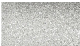
Рис. 3. Поверхность опытного образца детали после пескоструйной обработки
