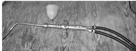
Рис. 5. Установка для нанесения газопламенного напыления на опытный образец
