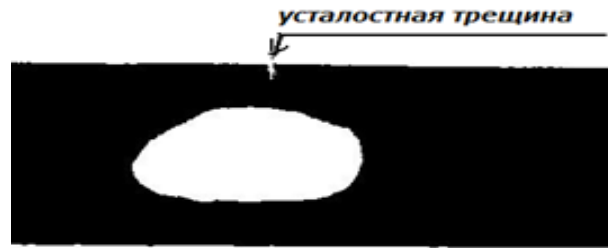
Рис. 2. Рентгенограмма образца с дефектом и усталостной трещиной
