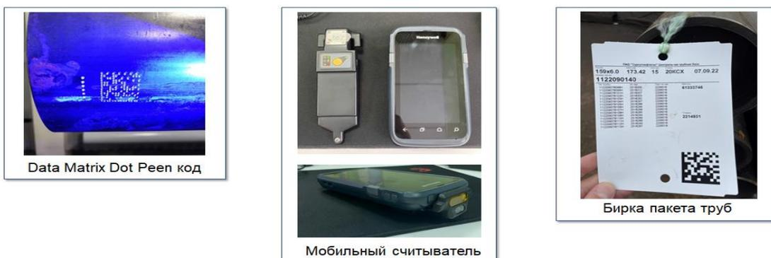
Рис. 2. Маркировка труб
