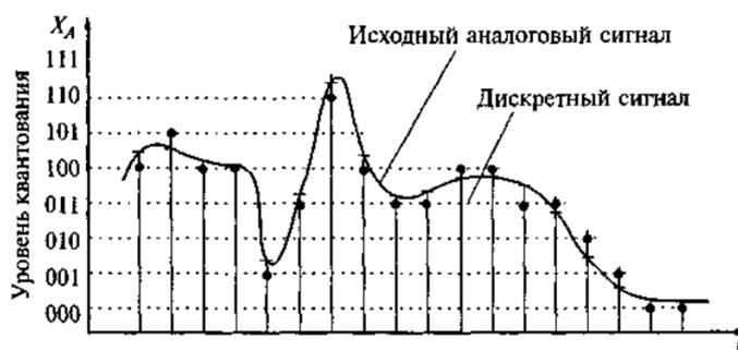
Рис. 1. Дискретизация аналогового сигнала
