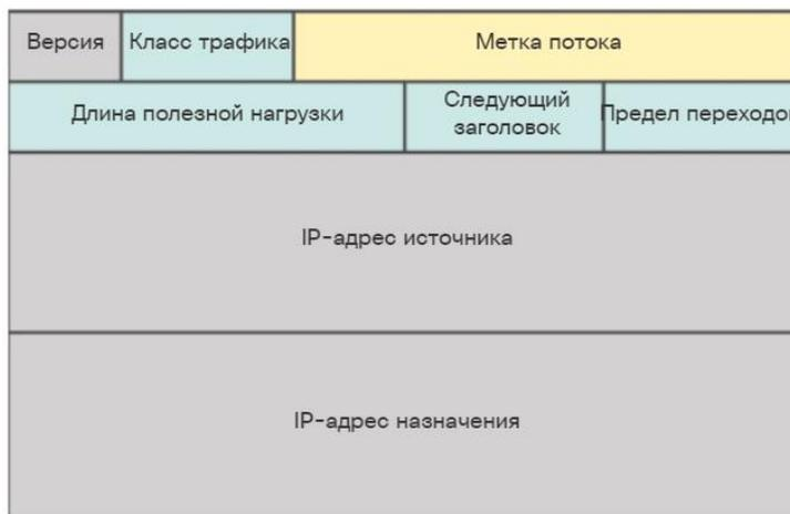
Рис. 3. Фрагмент заголовка пакета сетевого протокола IPv6
